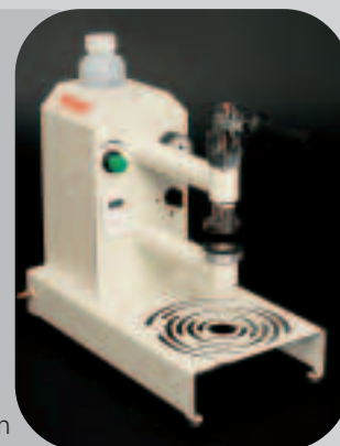
Station d'essai de la soudure Estación para comprobación de la costura
