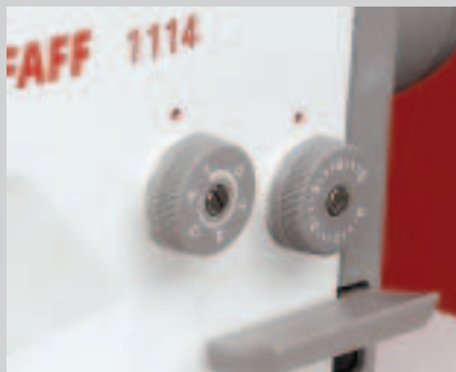
Réglage de la longueur de point par deux boutons pour la limitation des points en marche avant et arrière
